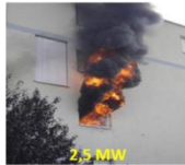
2,5 MW Une fenêtre (1,5x1m)
